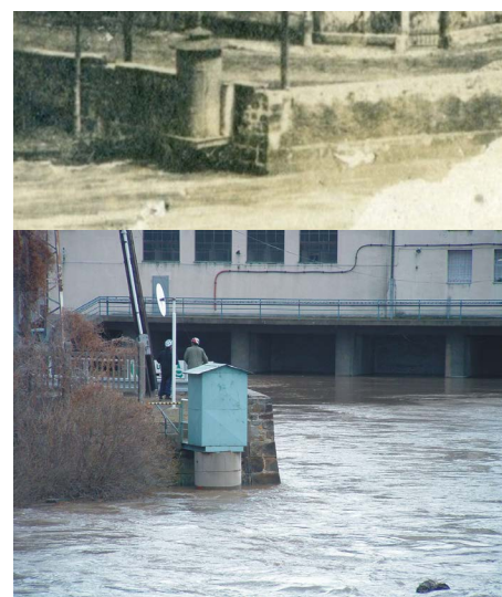
Obr. 5 Vodní stav na horním snímku souhlasí s vodním stavem za vrcholu povodně v dubnu 2006 (dole), tedy 315 cm (podle současné nuly vodočtu 515 cm)
